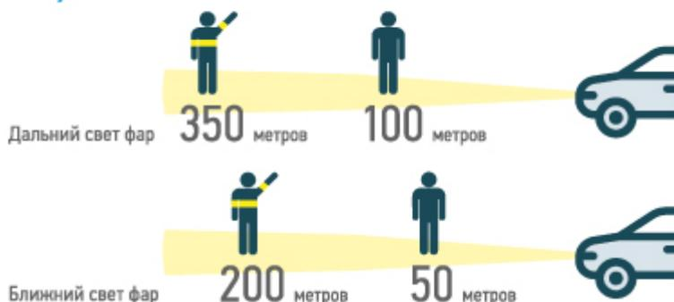
**Видимость пешехода в темное время суток.** Ближний свет фар позволяет водителю увидеть пешехода на дороге на расстоянии 25-50 метров. Если пешеход применяет световозвращатель, то расстояние увеличивается до 150-200 метров. При дальнем свете фар дистанция, на которой пешеход со световозвращателем виден, увеличивается до 350 метров.
